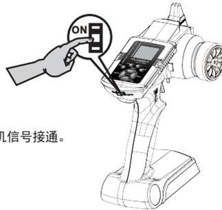
3. 当接收器上的LED灯由闪烁转为常亮时, 表示发射机与接收机信号接通。
