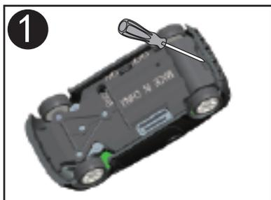
1. 用一字螺絲刀，插入車輛底盤尾部縫隙中。
